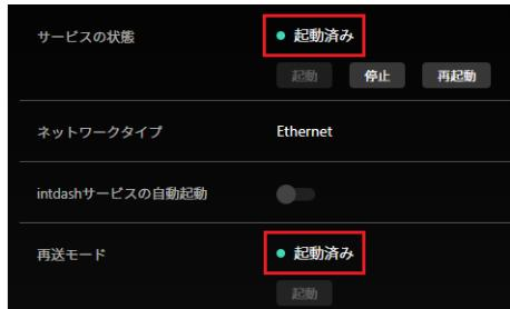
図 13 再送モードで起動した状態（再送モードは「起動済み」）
